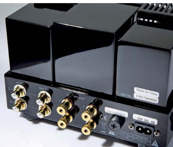
Line Magnetic har högtalarkontakter för att också kunna fungera som en liten bordsförstärkare.
